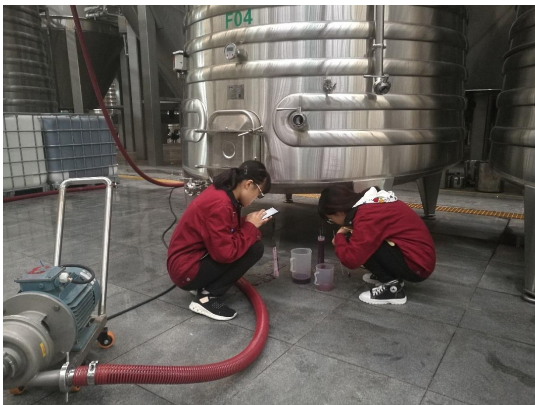
图4 学生酒厂生产实践-测定发酵过程中的比重
